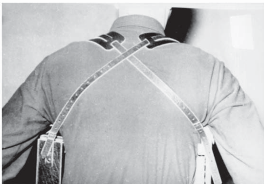
Il. 12.3. Uprząż skórzana do podtrzymywania detektora promieniowania i jego akumulatorów. Urządzenie wibrujące umieszczone pod pachą było używane do zaalarmowania operatora o wykryciu promieniowania
