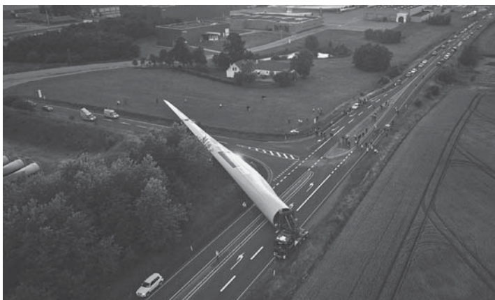
Rys. 15. Transport śmigła o długości 88,4 m do turbiny morskiej o mocy 8 MW
